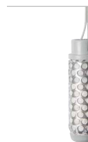
SC-PROBE Sonda de sensor de humedad del suelo Diámetro: 2,5 cm Altura: 8,3 cm Cable a la sonda: 30 m máximo Cable subterráneo directo de 1 mm 2
